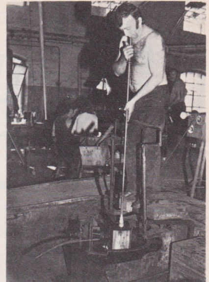
Soufflage d'un objet dans un moule en bois.
