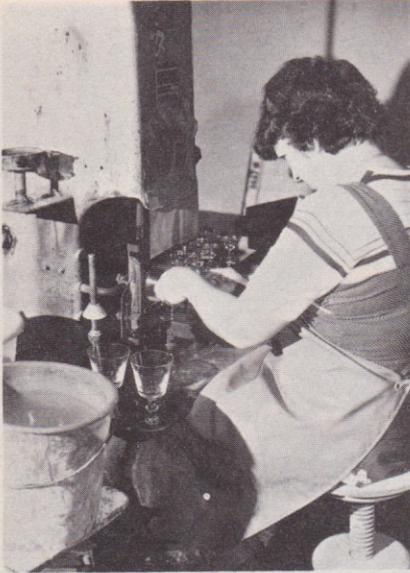
Finition du bord supérieur des objets après élimination du tranchant par fusion.
